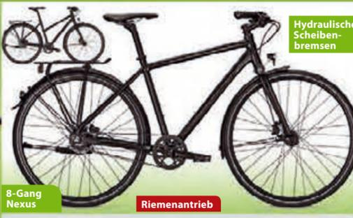
Leiser wartungsarmer Riemenantrieb Gate Carbondrive
